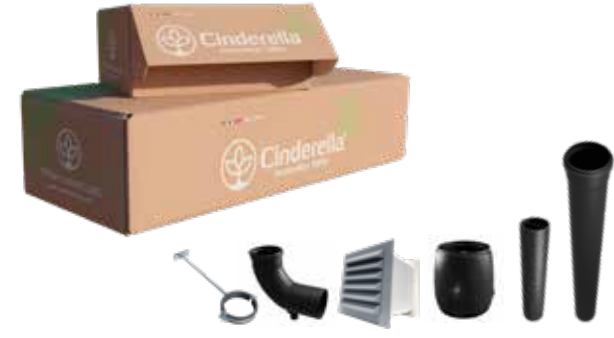
VOLLSTÄNDIGES ORIGINAL-INSTALLATIONS-SET FÜR CINDERELLA FREEDOM Das Installationsset enthält: 1 x Lufteinlass, 1 x Dachaufsatz, 1 x 87-Grad-Bogen, 3 x Rohrschellen/-halterungen, 2 x Rohre 500 mm, 5 x Rohre mit Steckmuffe 1.000 mm. Bitte beachten Sie, dass dieses Set KEINEN Gasdruckregler enthält.
